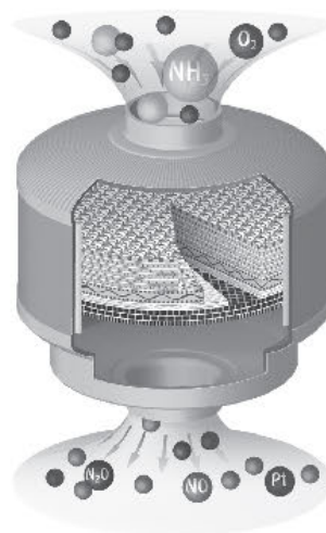
Hình 5.1. Mô hình buồng phản ứng oxi hoá ammonia
