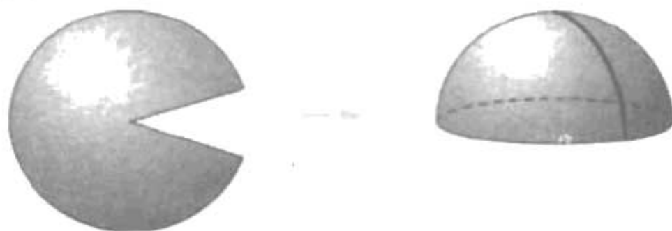
Hình 34. Tạo ra tấm vải có độ cong dương: ta cần phải cắt bỏ đi một miếng vải hình tam giác.
