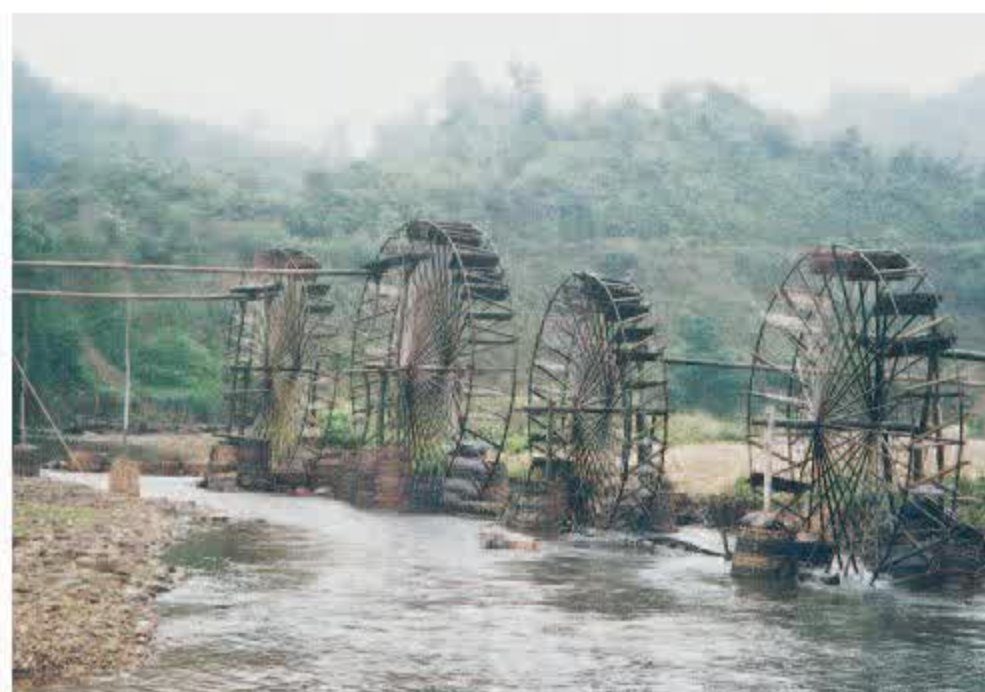
⑥ Bánh xe nước (cọn nước)
