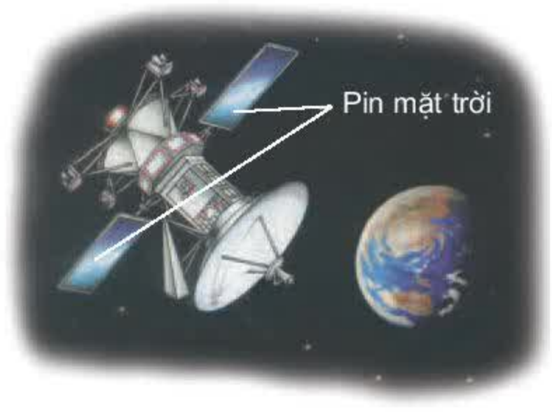
④ Sử dụng pin mặt trời trên vệ tinh nhân tạo
