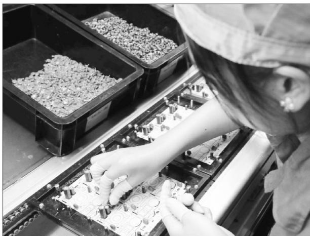
Lắp ráp linh kiện điện tử dùng cho ngành máy in tại Công ty TNHH công nghệ điện tử Chee Yuen Việt Nam.
