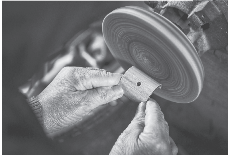
Bào mịn vỏ tre là một trong hai công đoạn duy nhất sử dụng máy trong “dây chuyền” sản xuất chuồn chuồn tre tại Thạch Xá. Ảnh: Mạnh Cường.
