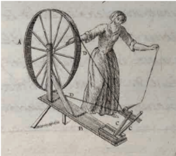
2.1 Kéo sợi bằng tay dùng 1 cọc suốt
