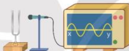
Hình 13.2 Thí nghiệm về mối quan hệ giữa biên độ dao động của nguồn âm và biên độ của sóng âm; biên độ của sóng âm và độ to của âm
