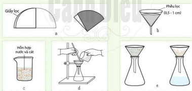
Hình 11.2. Các bước tách cát khỏi hỗn hợp cát với nước
