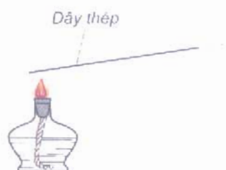
Hình 2.2 Thí nghiệm về tính dẫn nhiệt của kim loại
