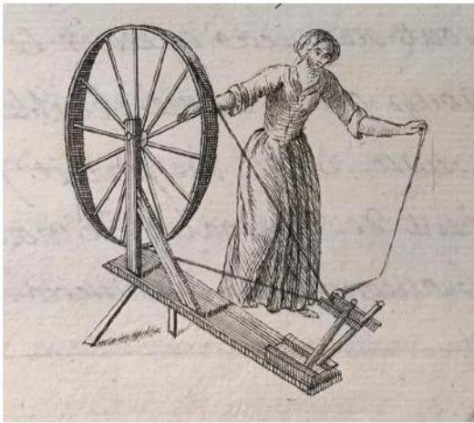
2.1 Kéo sợi bằng tay dùng một cọc suốt
