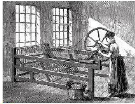
2.2 Máy kéo sợi Giê-ni 16 – 18 cọc sợi
