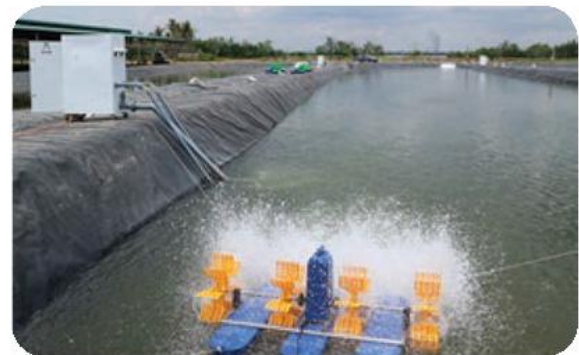
Hình 15.5. Máy quạt nước cho ao
