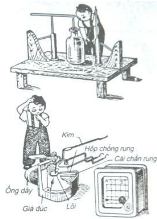
Hình 29 - Khí cụ đo điện đầu tiên: điện kế của Rich man (phía trên) và một kiểu ampe kế hiện nay
