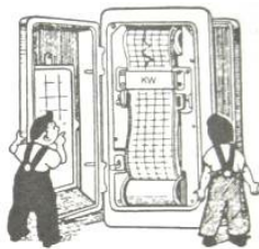
Hình 32 - Đây là một máy tự ghi, máy “tô cao”. Nó vẽ một đường cong trên băng giấy chuyển động liên tục, ghi lại trị số của một đại lượng điện nào đó.
