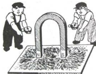
Hình 14 - Nam châm sắt bọc bạc những điều "bí ẩn" của nó. Trên tờ giấy có phủ bột sắt, ta thấy rất rõ các đường sức của nam châm hình móng ngựa.
