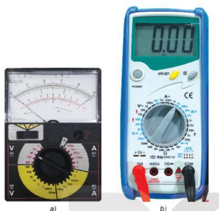
Hình 2.6. Đồng hồ đo điện đa năng kim khung quay a) và đồng hồ đo điện đa năng hiển số b)
