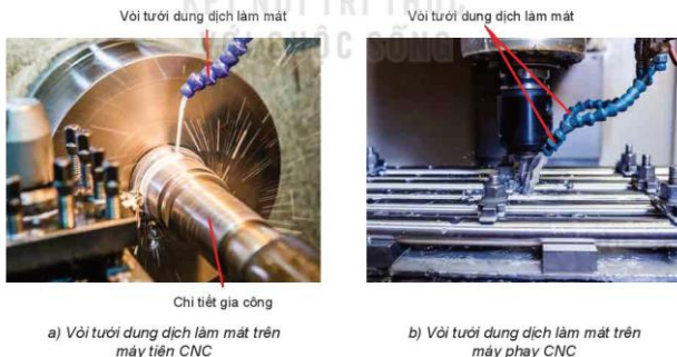
Hình 6.8. Vòi tưới dung dịch làm mát trên máy CNC
