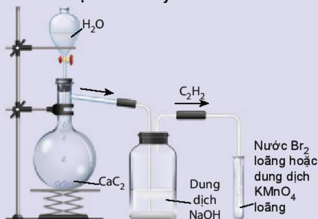
Hình 16.6. Điều chế acetylene và thử tính chất
