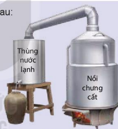
Hình 11.1. Thiết bị nấu rượu thủ công
