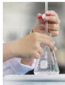
Hình 2.6. Chuẩn độ dung dịch NaOH bằng dung dịch HCl Hình 2.7. Thao tác khi chuẩn độ
