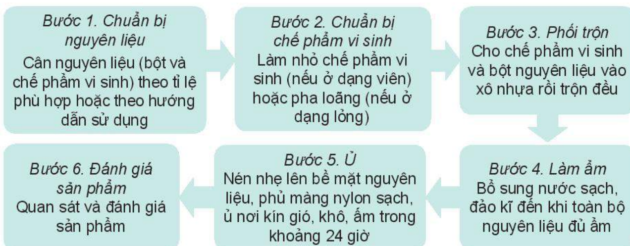
Hình 10.1. Các bước chế biến thức ăn giàu tinh bột bằng phương pháp lên men
