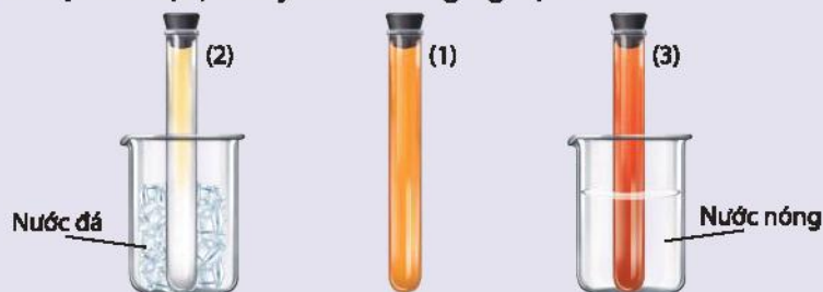
Hình 1.2. Ảnh hưởng của nhiệt độ đến sự chuyển dịch cân bằng 2\text{NO}_2(\text{g}) \rightleftharpoons \text{N}_2\text{O}_4(\text{g})
