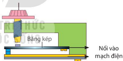
b) Băng kép đóng ngắt mạch điện
