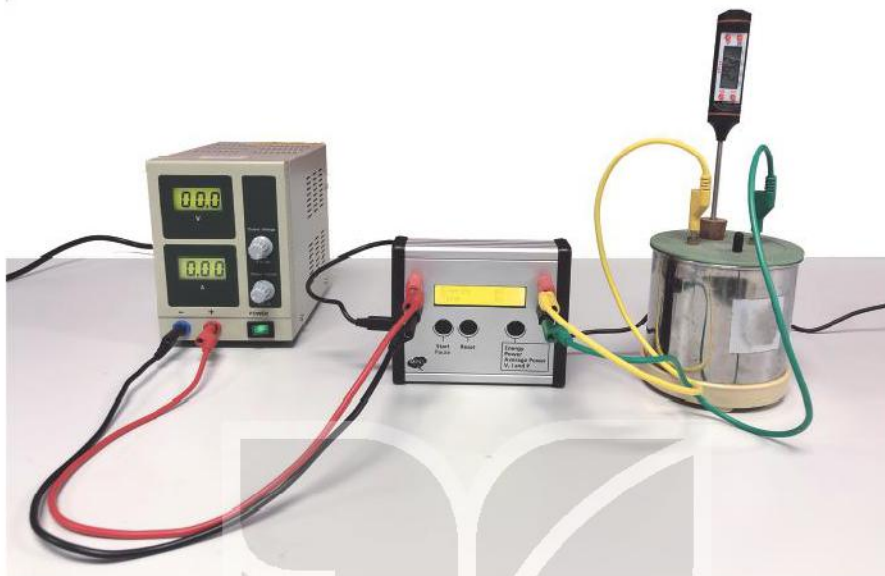
Hình 27.2 Bố trí thí nghiệm đo năng lượng nhiệt
