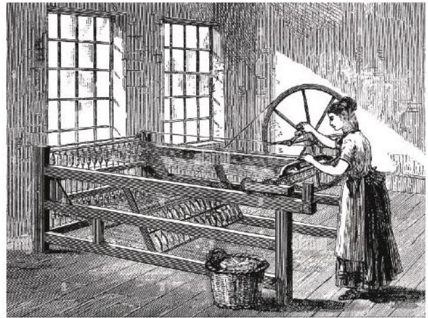
2.2 Máy kéo sợi Gien-ni 16 – 18 cọc suốt
