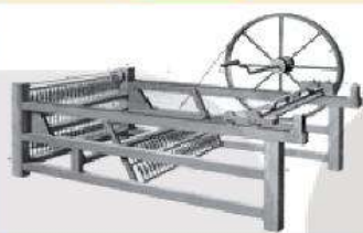
Hình 6. Máy kéo sợi Giên-ni (Giêm Ha-gri-vơ)
