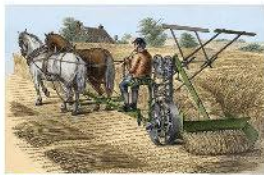
2.3 Máy gặt cơ khí – phát minh của C. M. Cô-mô (Cyrus McCormick) năm 1831
