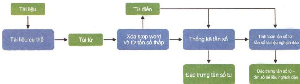
Hình 7-3: Luồng cơ bản của ứng dụng mô hình túi từ
