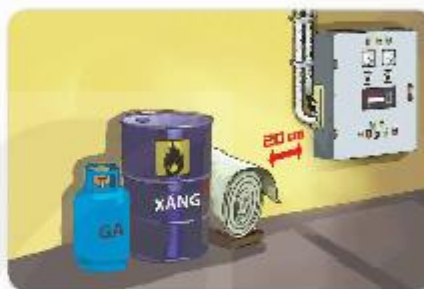
b) Chất đốt để gần tủ điện
