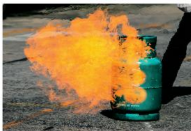
▲ Hình 12.2. Rò rỉ gas gây cháy nổ
