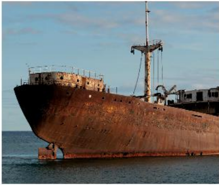
▲ Hình 11.4. Vỏ tàu biển bị ăn mòn
