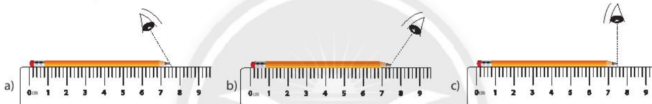
▲ Hình 4.5. Cách đặt mắt khi đo chiều dài
