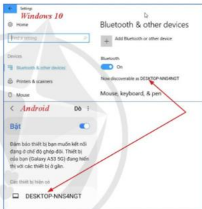
Hình 4. Kết nối máy tính với điện thoại thông qua Bluetooth
