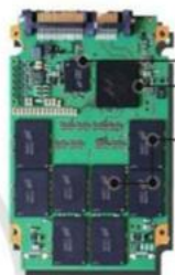
Hình 7. Cấu tạo bên trong ổ cứng SSD của máy tính
