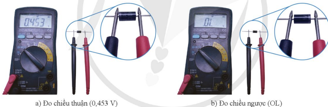
Hình 16.8. Cách đo kiểm tra diode
