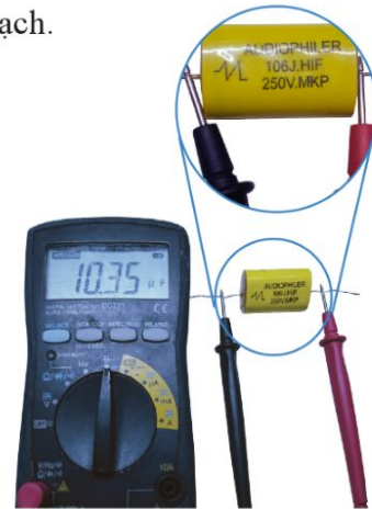
Hình 16.7. Cách đo kiểm tra tụ điện bằng đồng hồ vạn năng hiển số
