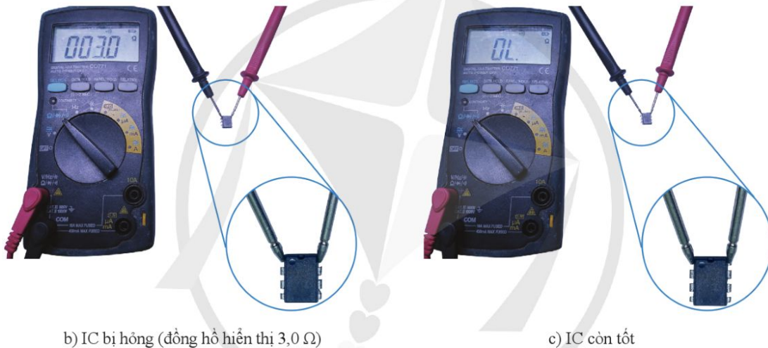
Hình 16.11. Kiểm tra tình trạng của IC PIC16F675
