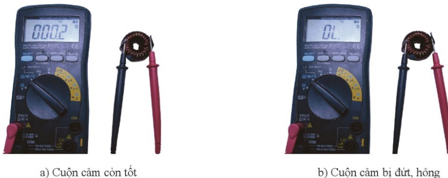
Hình 16.6. Cách đo kiểm tra cuộn cảm bằng đồng hồ vạn năng hiện số
