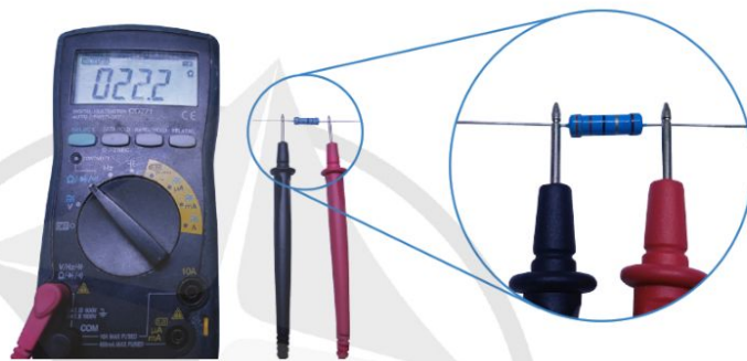
Hình 16.5. Cách đo kiểm tra điện trở bằng đồng hồ vạn năng hiện số
