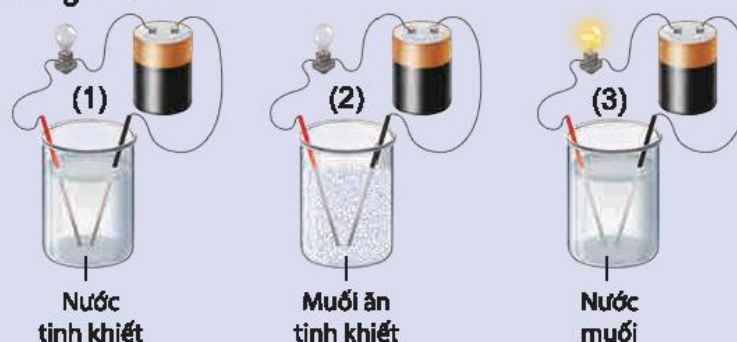
Hình 2.2. Thí nghiệm thử tính dẫn điện
